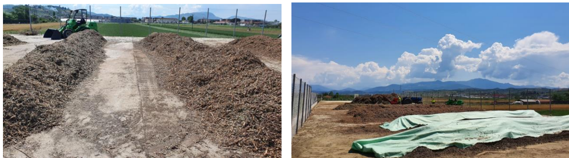
Figure 39. Impiant tipik kompostimi palë palë
